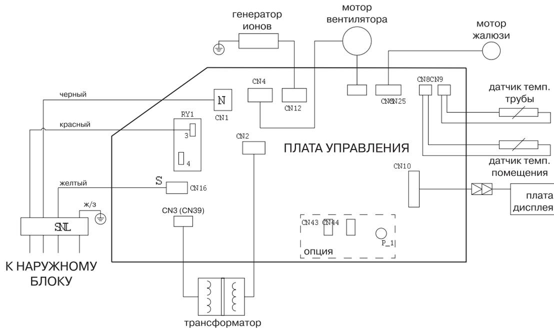
внутренний блок кассетного типа, 9 / 12 / 18 кВтU
