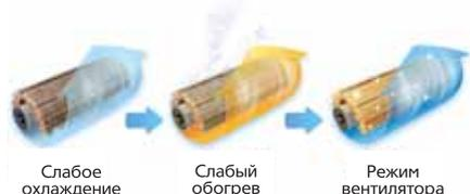
При активации этой функции после прекращения работы кондиционера его выключение происходит по специальному алгоритму. Сначала кондиционер работает в режиме охлаждения с низкой скоростью вентилятора для смыва частиц, оставшихся на теплообменнике, далее работа на обогрев на низкой скорости вентилятора для просушки теплообменника, и после этого в режиме вентиляции с низкой скоростью вентилятора. Эта функция способствует очистке внутренних частей блока.
